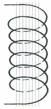
Bild 8-3: Magnetisches Feld im Inneren einer Zylinderspule
